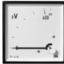
Doppelspannungsmesser mit 2 Dreheisenmesswerken.
